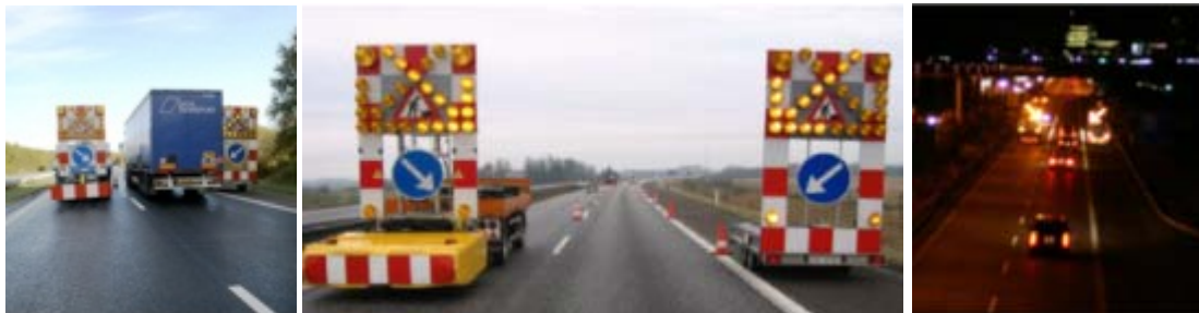
Figur 6.62. Eksempler på portopstillinger med afmærkningsvogne
