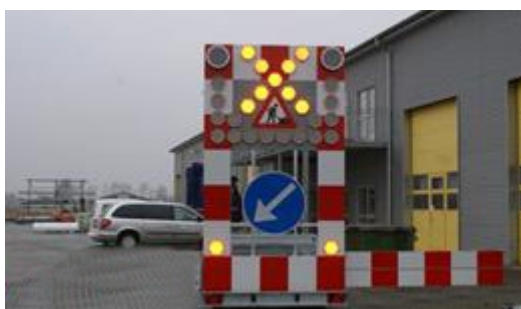
Figur 6.39. Eksempel på afspærringsvogn med sideforskydelig bom (skydebom).
