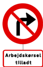
Figur 3.28. Eksempel på C 11 med undertavle som forbyder indkørsel til arbejdsområdet
